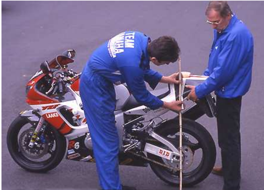
Erste Messung: Das Heck wird voll aus der Federung gehoben
